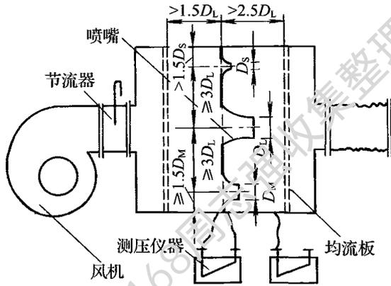
图 C. 2. 7-1 正压风室式漏风量测试装置
