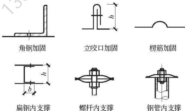
图 4.3.1 金属风管的加固形式
