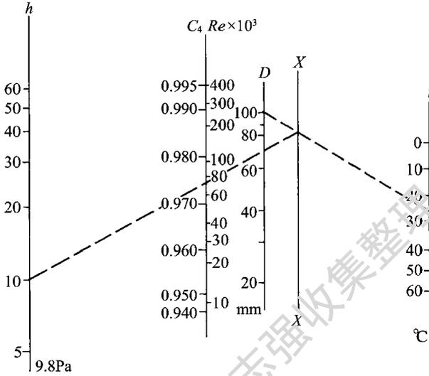
图 C. 2. 7-3 喷嘴流量系数推算图
