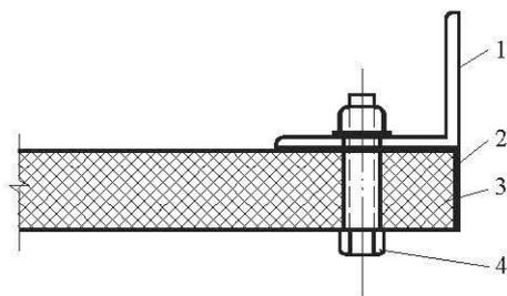
图 4.3.3 玻璃纤维复合风管角钢连接示意
