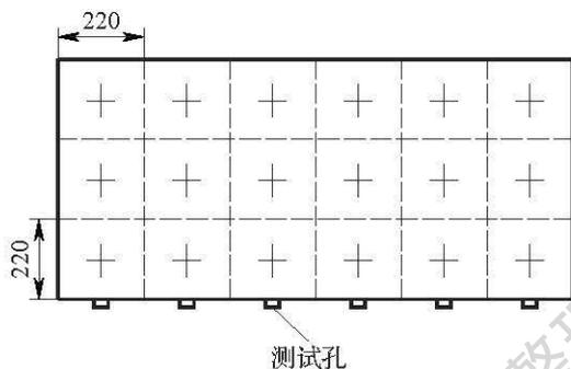
图 E. 1. 3-1 矩形风管测点布置示意
