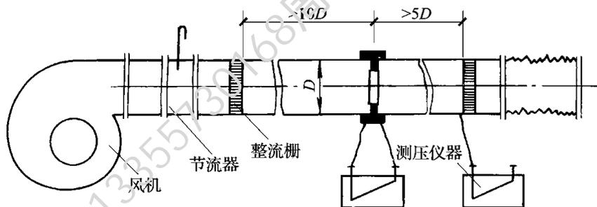
图 C. 2. 6-1 正压风管式漏风量测试装置
