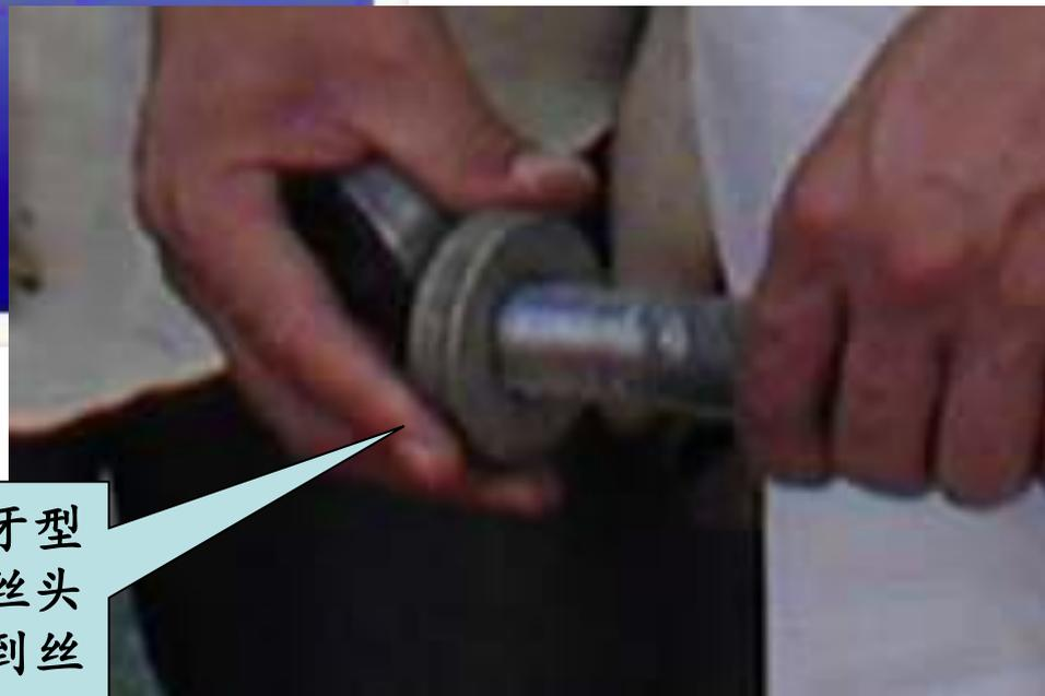
用通、止规检测丝头牙型和齿面：通规能拧到丝头最底部，止规只能拧到丝头第三丝扣
