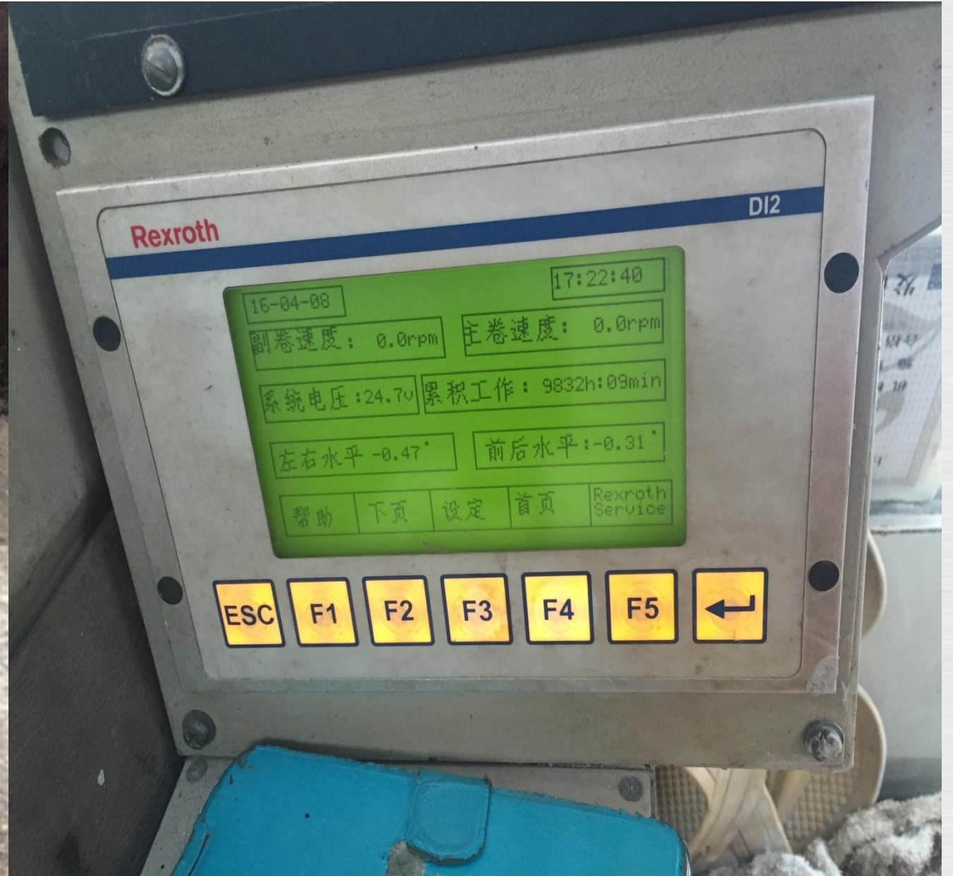
在司机方便读取的位置有水平度数据显示
