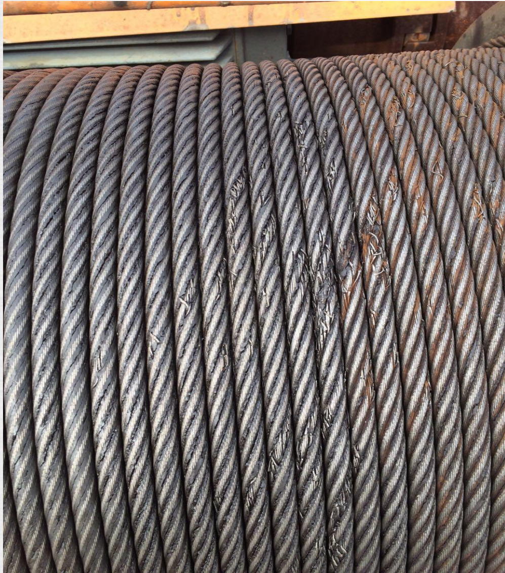
日常检查案例：钢丝绳断丝数严重超标
